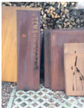
Beispiel für berosteten Cortenstahl in verschiedenen Farbnuancen.
