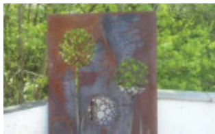
Schwarze Verfärbungen durch Luftabschluss und Feuchtigkeit auf der jungen Oberfläche.
