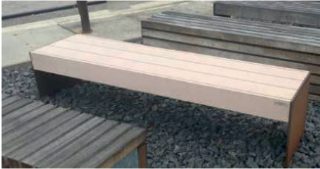
Beispiel: Vergleich Vergrauung RESYSTA® und Hartholz nach ca. 24 Monaten
