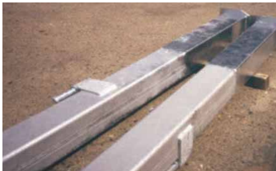
Beispiel für zulässige Unterschiede in der Oberfläche nach dem Verzinken (Bildquelle: Beuth-Verlag, Korrosionsschutz Feuerverzinken).
