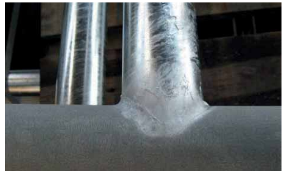
Beispiel für zulässige Unterschiede in der Oberfläche nach dem Verzinken (Bildquelle: Beuth-Verlag, Korrosionsschutz Feuerverzinken).
