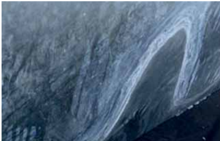
Beispiel: Weißrost an einer Sitzbank nach falscher Zwischenlagerung auf der Baustelle.
