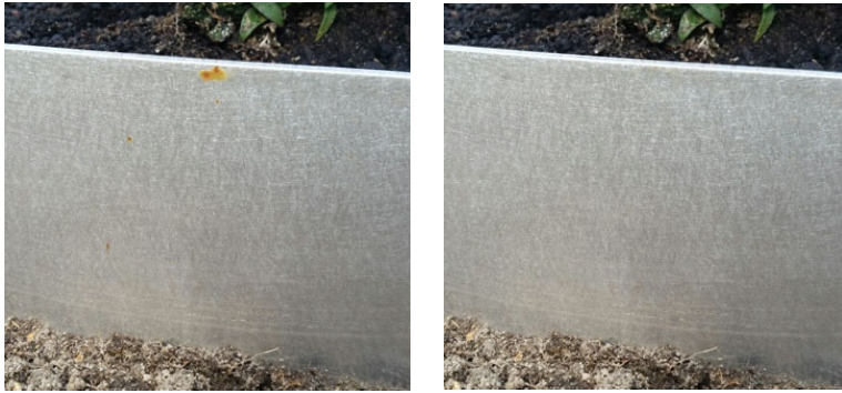
Anwendungsbeispiel von EDELSTAHL-LOTION zur Entfernung von Korrosionsflecken auf Edelstahl.
