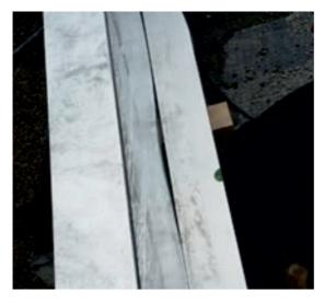
Typischer lokaler Verzug bei flächigen, feuerverzinkten Elementen. Der Verzug ist verfahrenstechnisch bedingt und innerhalb der zulässigen Norm
