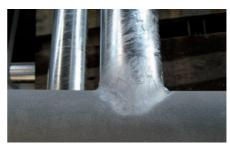
Beispiel für zulässige Unterschiede in der Oberfläche nach dem Verzinken (Bildquelle: Beuth-Verlag, Korrosionsschutz Feuerverzinken).
