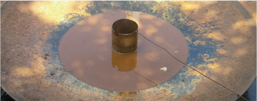
*Schale mit Rostspuren sowie rostigem Wasser. Grund: Die Ablaufbohrungen in der Wasserschale sind durch Schmutz verstopft. Dadurch konnte die Wasserschale nicht regelmäßig abtrocknen. Lösung: Reinigen Sie die Schale regelmäßig, damit sich die Löcher nicht zusetzen und es nicht zu Staunässe kommt.*
