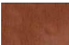
Edelrostopik Cortenstahl vorgerostet Werkstoff-Nr.: 1.8965
