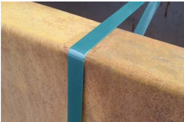
Abdrücke von Spanngurten entstehen beim Verpacken
