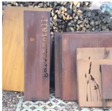
Beispiel für berosteten Cortenstahl mit unterschiedlichen Farben nach dem ersten Berosten
