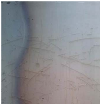
Beispiel für walzblanke Oberfläche vor der Bewitterung
