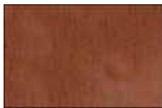
Edelrostoptik Cortenstahl vorgerostet Werkstoff-Nr.: 1.8965
