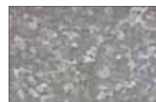
Stahl feuerverzinkt (15) nach DIN EN ISO 1461
