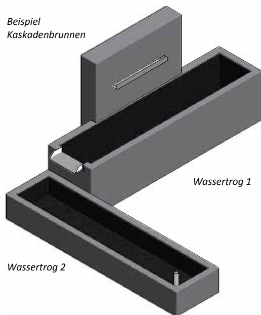
Kaskadenbrunnen mit zwei Wassertrögen
