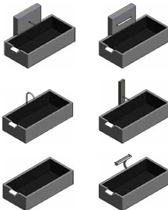
Varianten Wassereinlauf Kaskadenbrunnen
