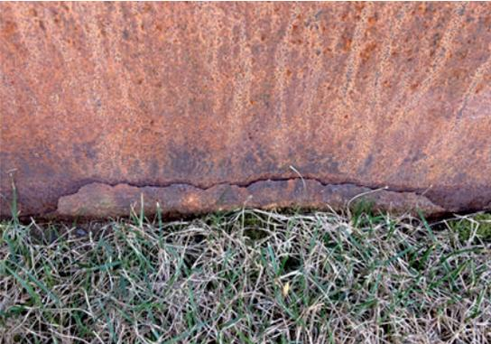
*An diesem Pflanztrog konnte sich durch die Staunässe in Kombination mit der sauren Umgebung keine Schutzschicht bilden. Der Pflanztrog rostete innerhalb kurzer Zeit wie normaler Stahl durch. Einfache Lösung: Pflanztrog rundum mit 2-5 cm Splitt umgeben.*
