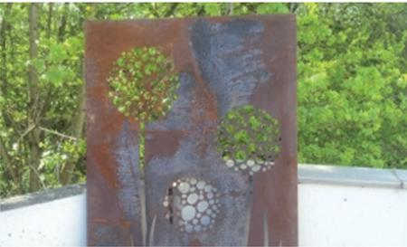
*Schwarze Verfärbungen durch Luftabschluss und Feuchtigkeit auf der jungen Oberfläche.*
