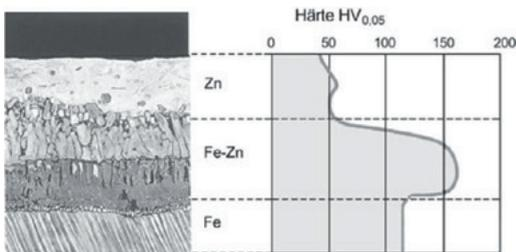
*Härteverlauf innerhalb der verzinkten Oberfläche: Die Härte nimmt in der Übergangsschicht zum Grundmaterial zu.
