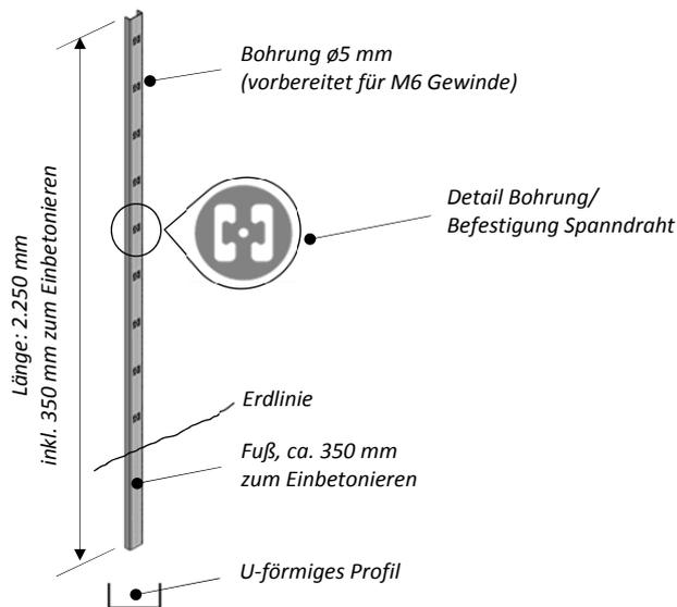
Rankpfosten U-förmig 60x25 mm<sup>2</sup> zum Einbetonieren
